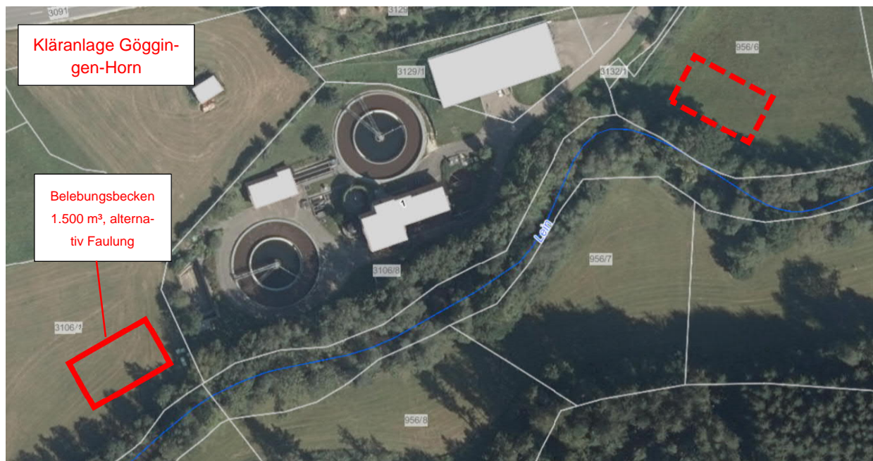
Abbildung 36: Kläranlage Göggingen-Horn Schematische Darstellung der Erweiterungen (Landesanstalt für Umwelt Baden-Württemberg, 2022)
